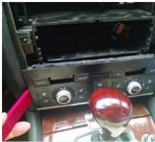
16. Hebeln Sie die Klimaanlage des Originalfahrzeugs heraus
