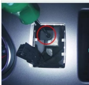
7. Entfernen Sie die Befestigungsschrauben des Originalbildschirms des Fahrzeugs
