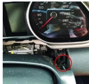
11. Entfernen Sie die Befestigungsschrauben des Original-Fahrzeugsbildschirms
