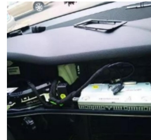
12. Entfernen Sie die Verkleidung.
