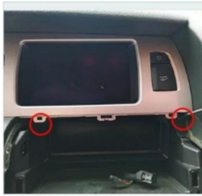
4. Entfernen Sie die Befestigungsschrauben des Original-Autoscheibenschutzes
