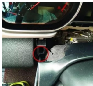
10. Entfernen Sie die Befestigungsschrauben des Original-Fahrzeugsbildschirms
