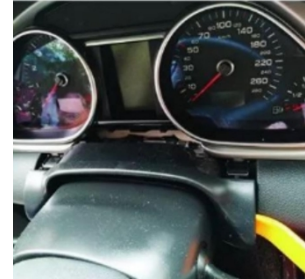
9. Entfernen Sie die Befestigungsschrauben des Originalbildschirms des Fahrzeugs.
