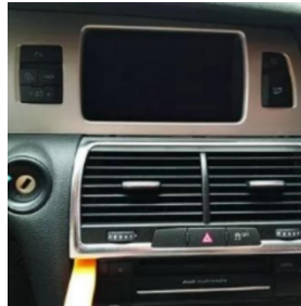
2. Hebeln Sie die Original-Luftauslassblende heraus
