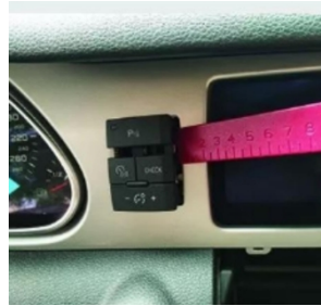
5. Entfernen Sie die Knöpfe auf beiden Seiten des Original-Fahrzeugsbildschirms
