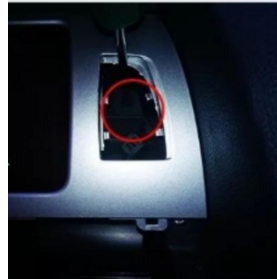
8. Entfernen Sie die Befestigungsschrauben des Original-Fahrzeugsbildschirms
